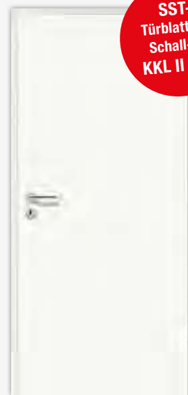
Schallschutz-Türblatt (SST), Weisslack mit Eckkante (EC), Schallschutz (Rwp 32dB), Klimaklasse II, und III inkl. Schall-Ex-Bodendichtung und Bänder V0026WF, PZ-vorgerichtet
