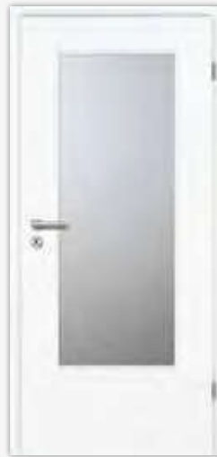
Weisslack Exklusiv LA-DIN KR-Kante mit Röhrenspanplatte (RSP) und Zarge mit runder Futterplatte und Bekleidung mit kl. Rundkante
